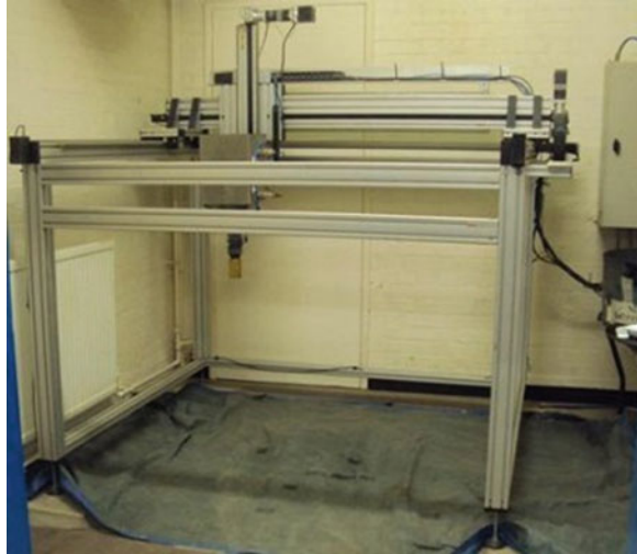
Fig. 24.7 Automatic sand pourer
